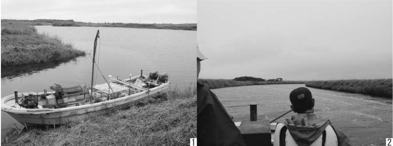
写真 1. 調査に使用した天塩漁協の船と儀装状況 (左舷に SC-3, 右舷にサイドスキャンソナーを設置, 背景は天塩川)
