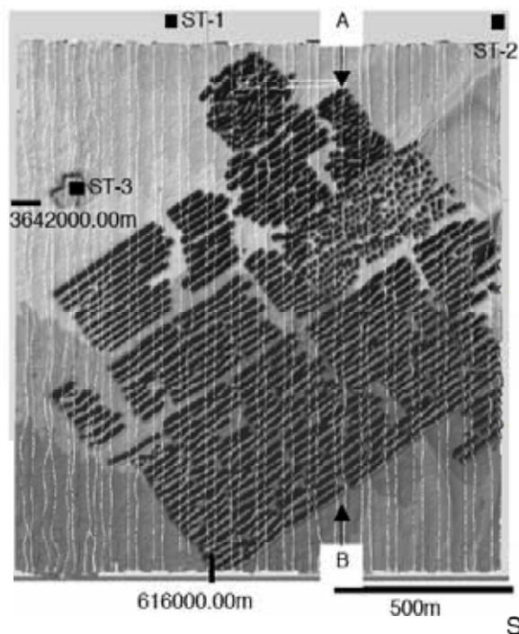
図 2. 浚渫地の地形, 西首 (2002) の地形断面と比較した測線 (A-B) および水質測定および底質試料採取地点 (ST-1, ST -2, ST -3)
